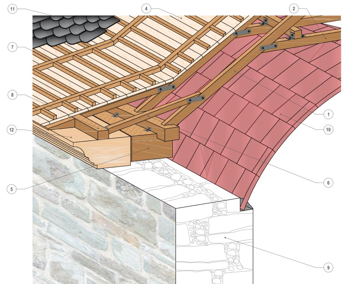
DETALLE ENCUENTRO BOVEDA CON MURO Y ESTRUCTURA DE CUBIERTA CON REFRENO. E: 1/10
